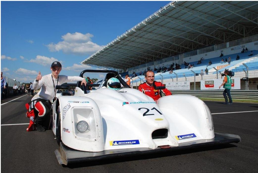
570kg, châssis biplace en carbone. Moteur Honda 4 cylindres deux litres développant 255 chevaux. Boîte de vitesses séquentielle à 6 rapports avec palettes au volant. Une excellente maniabilité proche de la monoplace mais avec davantage d'appui aérodynamique. Ce sport proto vous fera découvrir des vitesses de passage en courbe hallucinantes !
