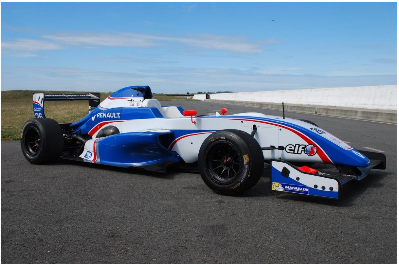
490kg, châssis monoplace en carbone. Moteur deux litres de cylindrée développant 210 chevaux. Boîte de vitesses séquentielle à 7 rapports avec palettes au volant. C'est l'outil idéal pour se préparer à la compétition moderne ou se perfectionner avant de conduire de plus grosses autos.
