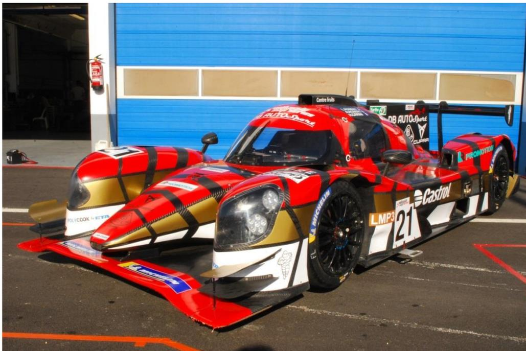
900kg, coque et carrosseries carbone. V8 Nissan de 5 litres de cylindrée pour 420 chevaux. Boîte de vitesses séquentielle à 6 rapports avec palettes au volant. Toute la technologie des voitures modernes d'endurance avec un niveau de sécurité maximum. Découvrez des sensations uniques de puissance à presque 300 km/h sur les plus beaux circuits d'Europe.
