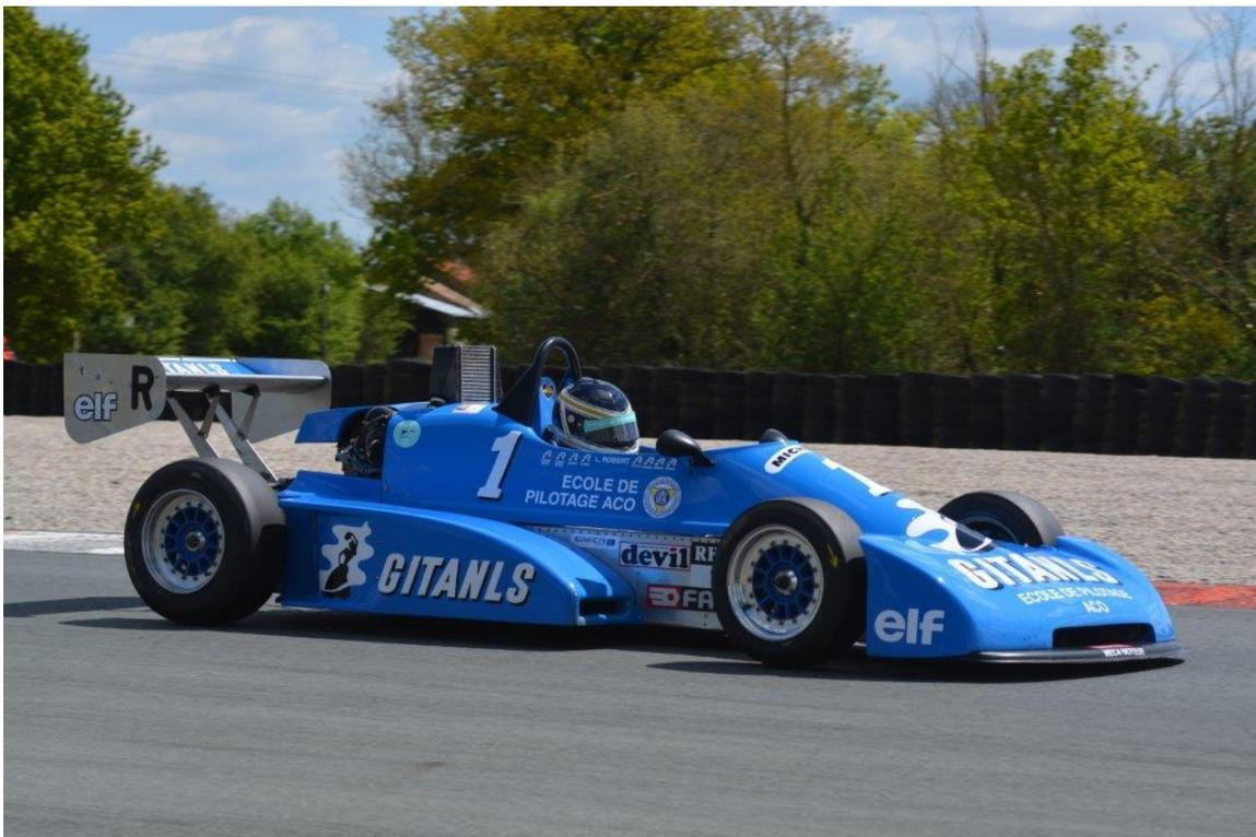
465kg, châssis tubulaire en acier. Moteur Renault 4 cylindres turbo de 140 chevaux. Boîte de vitesses manuelle à 5 rapports. Une monoplace très facile à prendre en mains. Un coût de fonctionnement raisonnable assurant un rapport prix / plaisir imbattable.
